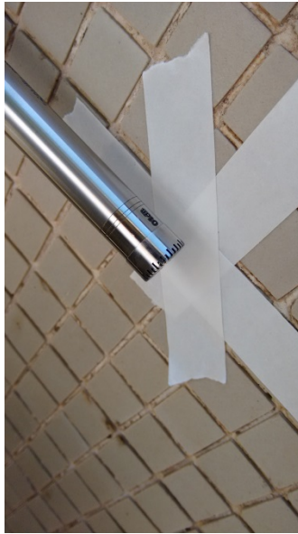
Figura 2: Microfone posicionado paralelamente com relação à fachada.
